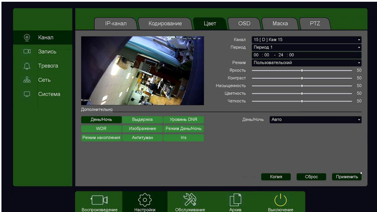
**Канал** – канал регистратора, к которому подключена камера.
