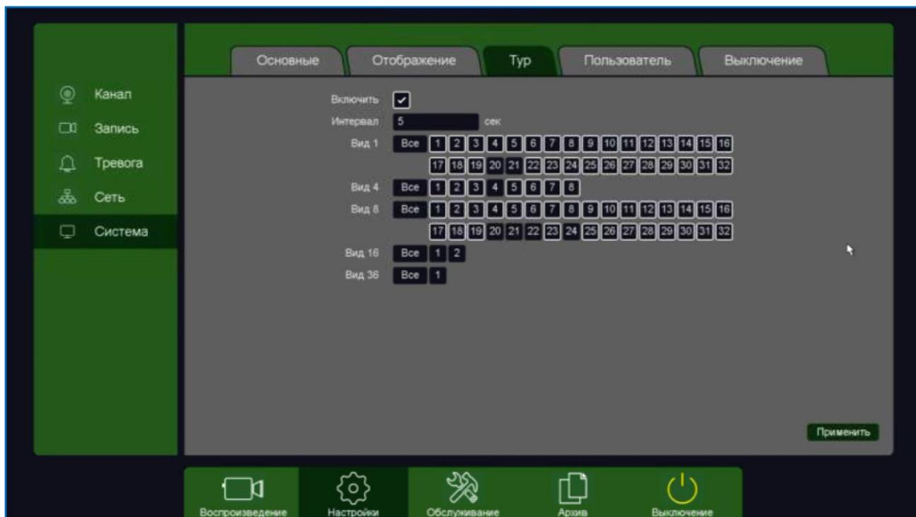
В данном меню можно настроить автоматическую смену через заданный интервал шаблона отображения на мониторе и выбрать отображаемые на данных шаблонах камеры.
