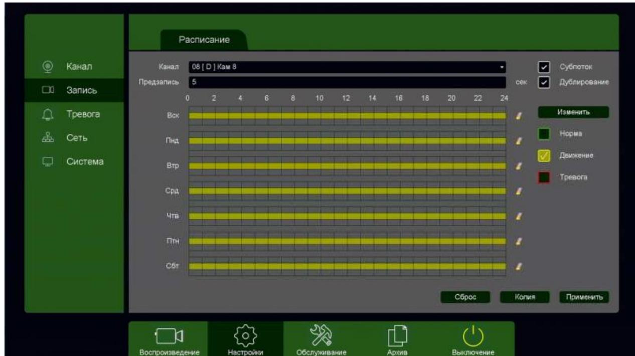
Постоянная запись по расписанию на FTP возможна, но так как длина файлов записи при записи по расписанию не регулируется, то невозможно предсказать момент начала синхронизации и записи на FTP (регулировка длины записи файлов при непрерывной записи будет добавлена в новых версиях прошивки).
