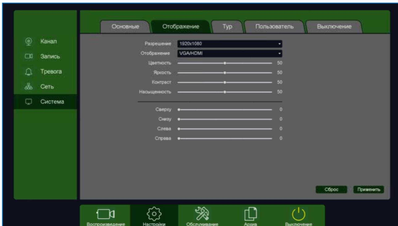
**Разрешение** – разрешение изображение на подключенном мониторе.
