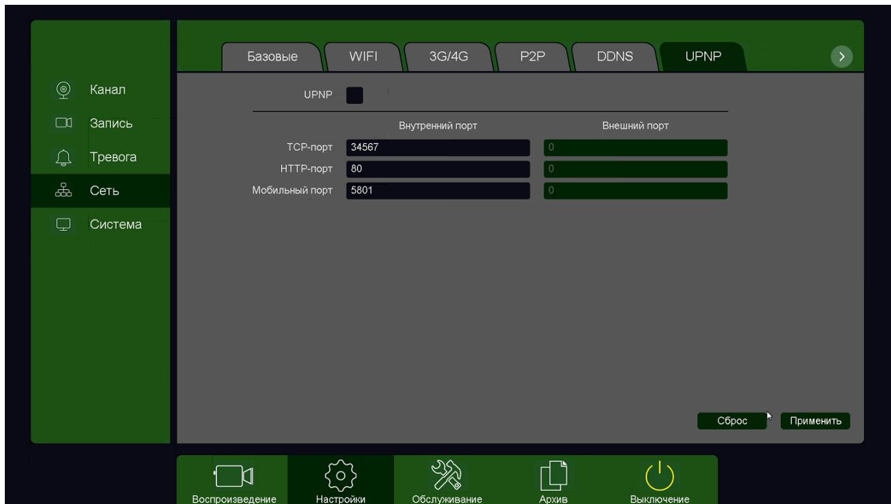
Если включено UPnP, то при поддержке данной функции маршрутизатором устройство автоматически транслирует порты через NAT маршрутизатора.
