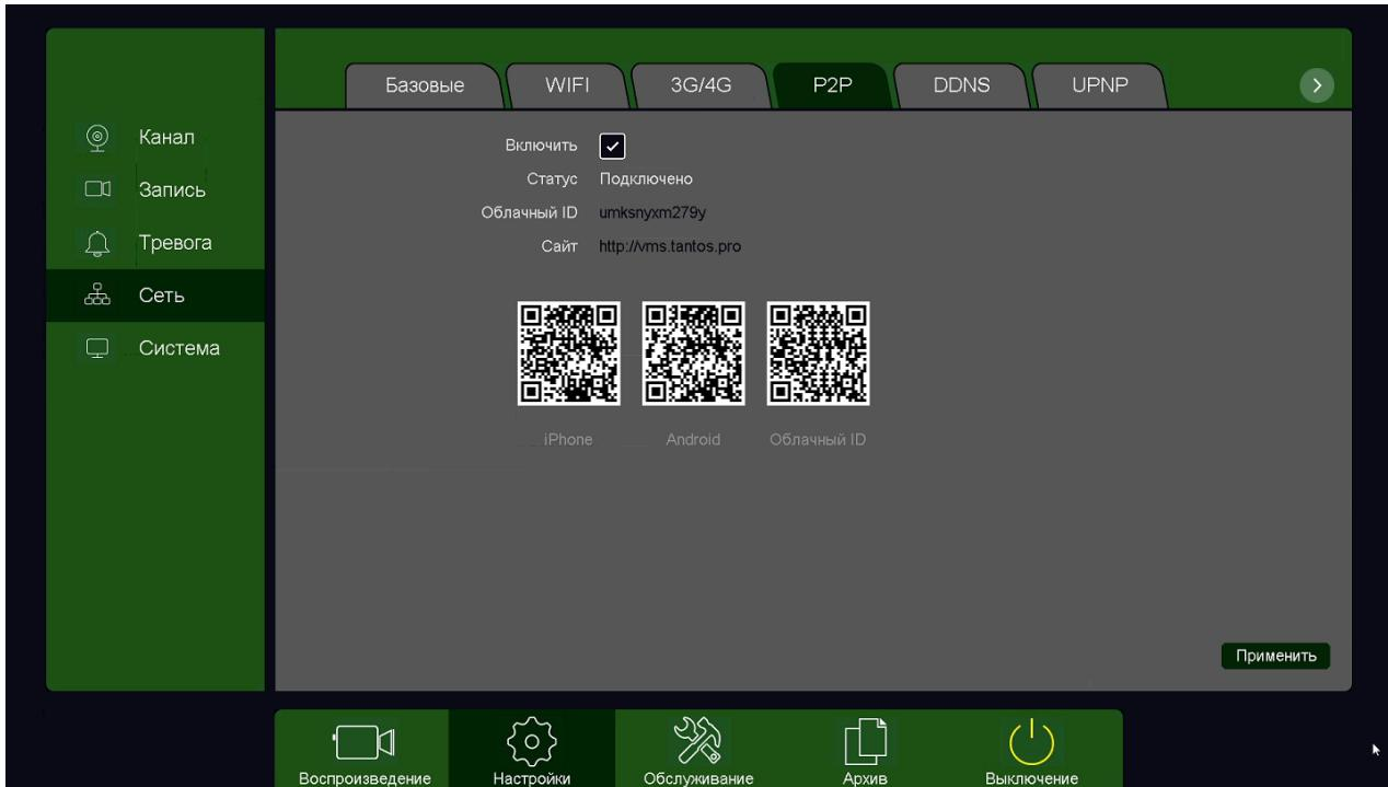
При включении этой функции видеорегистратор автоматически устанавливает соединение с сайтом <http://vms.tantos.pro>. При этом не требуется никаких настроек роутера, связанных с пробросом портов и наличием выделенного IP адреса.
