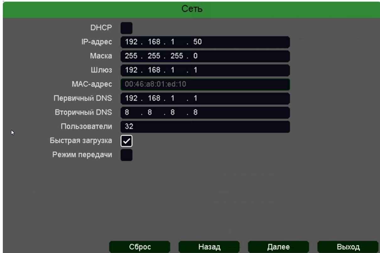
Можно задать получение адреса регистратором от DHCP (при этом необходимо, чтобы сервер DHCP был в сети) сервера при установке параметра **DHCP**, либо вручную.
