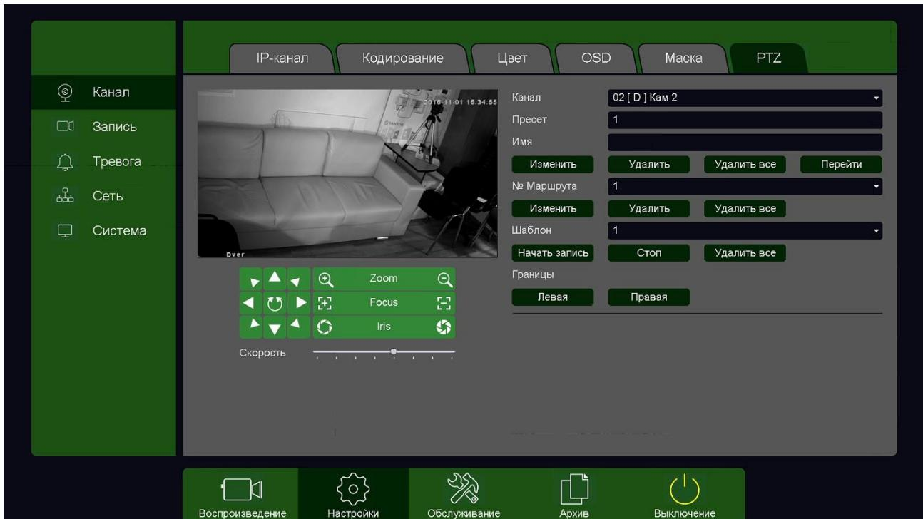
В данном меню производится настройка пресетов, маршрутов и шаблонов подключаемой PTZ камеры.
