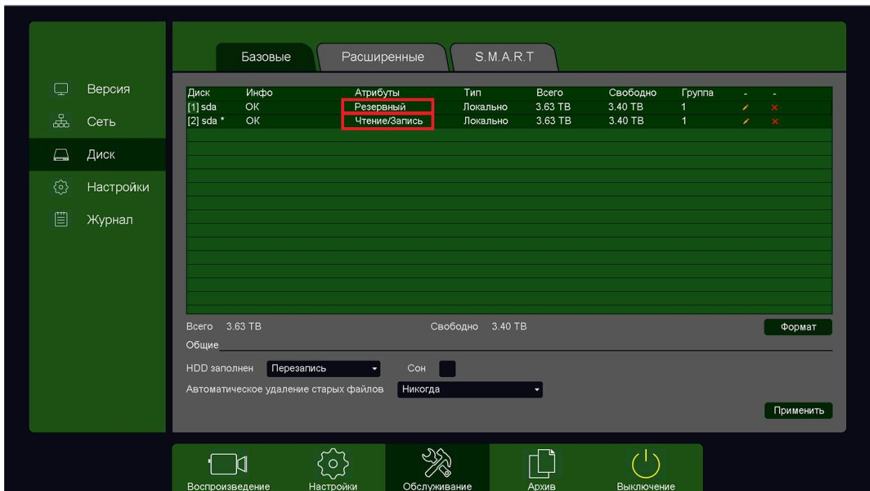
При этом один HDD должен иметь атрибут **Чтение/Запись**, а второй HDD должен иметь атрибут **Резервный**.
