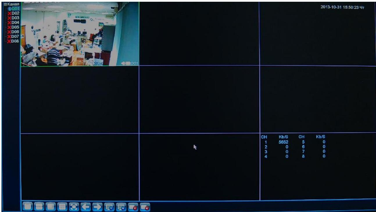
С левой стороны находится список камер, в правом верхнем углу отображается текущая дата и время регистратора, в правом нижнем углу отображается битрейт подключенных камер.
