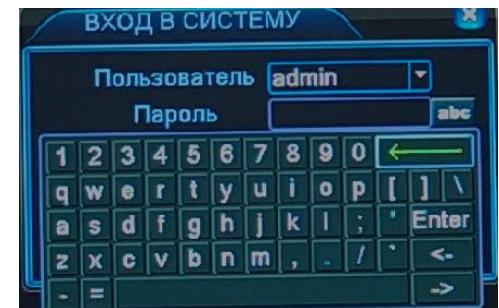
**Примечание:** если последовательно введены три неверных пароля, включается тревога. Если последовательно введены пять неправильных паролей, доступ к регистратору блокируется. После перезапуска регистратора или через полчаса, доступ автоматически разблокируется.
